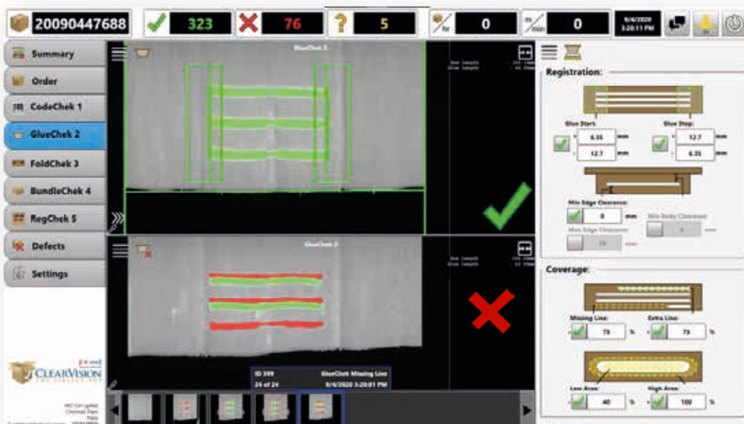
Installazione di doppia telecamera per ispezione del lato posteriore per rilevare residui di colla
