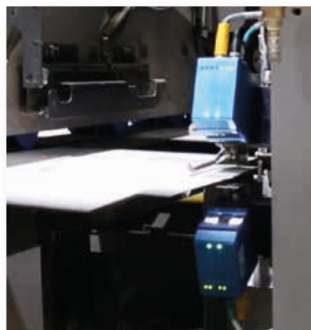
Installazione di doppia telecamera per ispezione del lato posteriore per rilevare residui di colla
