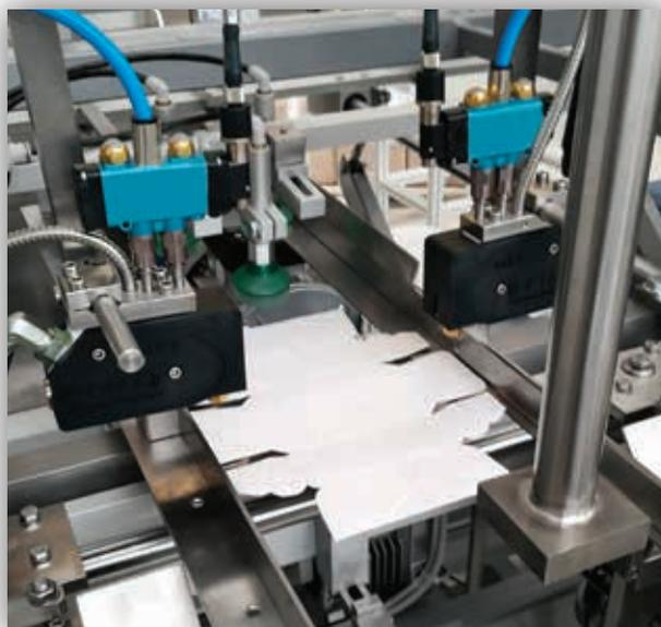
La Pistole della serie MK-F offrono due opzioni di modulo: a sfera o a cavità zero. Sfera, i mini moduli funzionano con ugelli standard dritti, a 90° e sferici. Cavità zero i mini moduli offrono un'erogazione estremamente rapida e precisa del tratto colla con qualsiasi tipo di adesivo.
