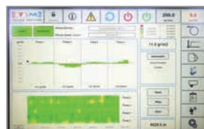
Controllo della grammatura Weight-Inspekt che funziona ad anello chiuso
