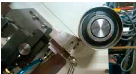
Il sistema chiuso per tubiera evita lo spreco di adesivo
