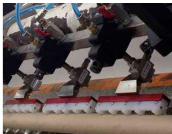
Gli applicatori possono essere facilmente rimossi per essere puliti o sostituiti
