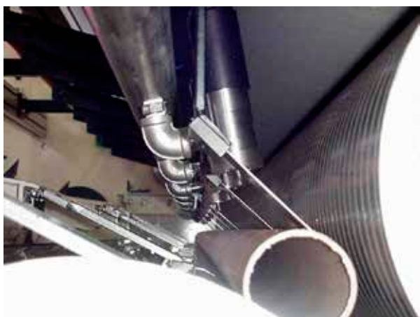
Il sistema chiuso e pressurizzato di Valco Melton applica tratti colla uniformi a tutte le velocità
