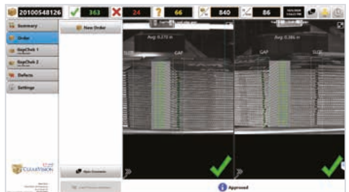
Mostra ogni singola misurazione del gap attraverso la semplice interfaccia utente di ClearVision
