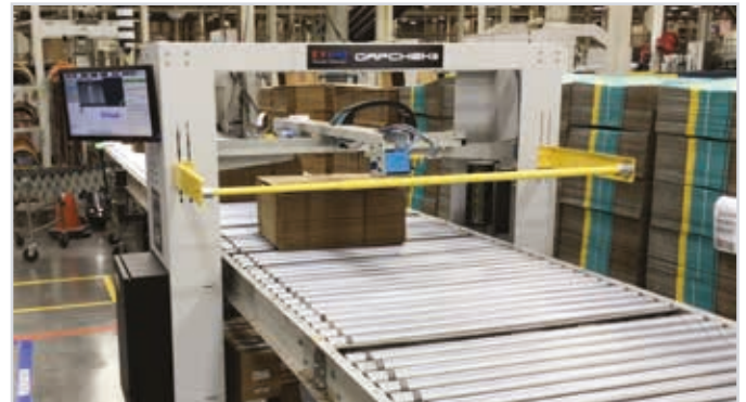
Possibilità di montaggio su trasportatore flat top o a rulli esistente
