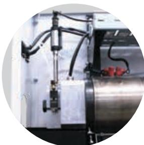
I trasduttori di pressione in uscita attivano il modulo di scarico per evitare sovrappressioni sul sistema
