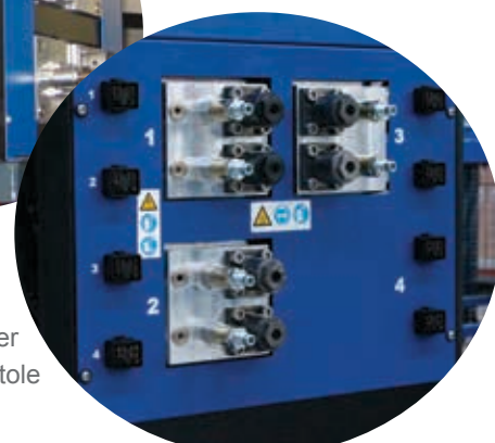
Facile accesso ai collettori della pompa
